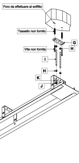
Al fine di fissare le barre filettate (I) alle piastre di fissaggio a soffitto (G), avvitare il dado (H) per almeno 20 mm. alla parte superiore della barra filettata.
