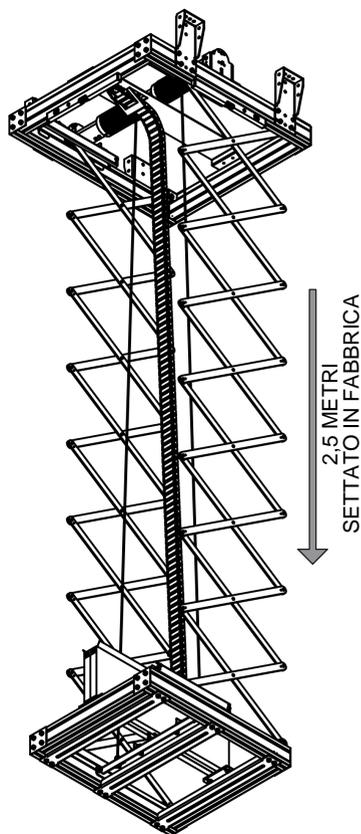
Prima di procedere con il montaggio del proiettore, utilizzare il telecomando in dotazione, premendo una volta il pulsante ▼ del telecomando per far scendere l'elevatore alla posizione del fine corsa in basso (modalità manutenzione) settato in fabbrica (circa 2,5 mt.).
