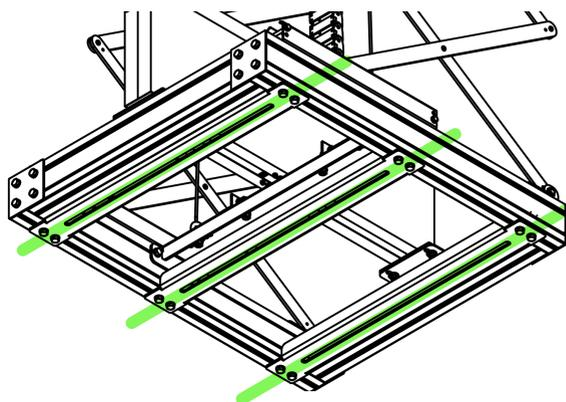
Per fissare il proiettore, far corrispondere la fresata delle 3 staffe regolabili del riquadro inferiore dell'elevatore con l'alloggiamento delle viti per l'ancoraggio delle viti per l'ancoraggio a soffitto del proiettore.
