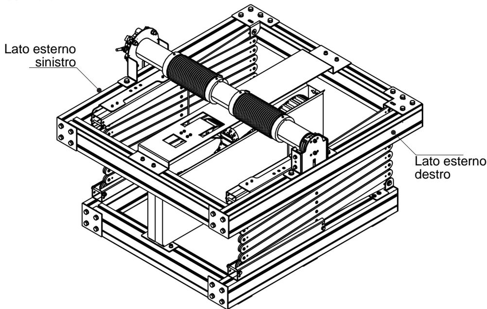
Il dado quadro (F) dovrà essere inserito all'interno della cava, come da schema seguente. Per ogni staffa dovranno essere predisposte n. 2 viti, rondelle e dadi nella cava superiore e n. 2 viti, rondelle e dadi nella cava inferiore. Non serrare completamente la vite prima di aver bloccato la staffa (C) alla misura richiesta per l'installazione.
