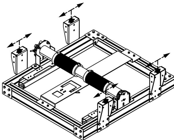
Agganciare l'elevatore a soffitto (viti e tasselli NON forniti a corredo) tramite gli appositi fori, avendo cura che la parte superiore dell'elevatore sia perfettamente in bolla, sia in larghezza che in profondità.
