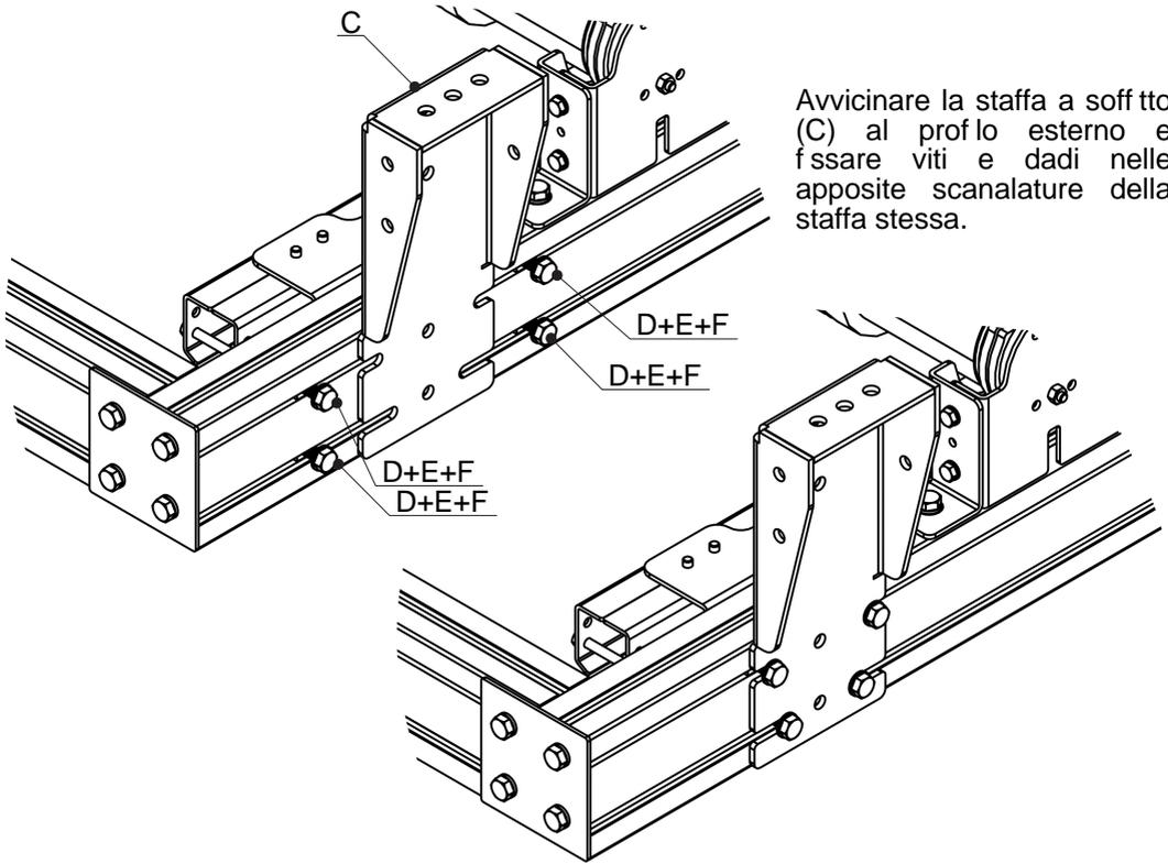
Avvicinare la staffa a soffitto (C) al profilo esterno e fissare viti e dadi nelle apposite scanalature della staffa stessa.
