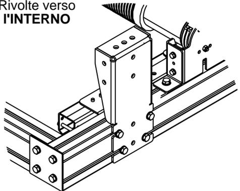
Individuare le posizioni delle staffe consone all'installazione lungo il profilo, serrare le viti delle staffe, 4 per ogni staffa, in modo definitivo e procedere con l'installazione a soffitto dell'elevatore.
